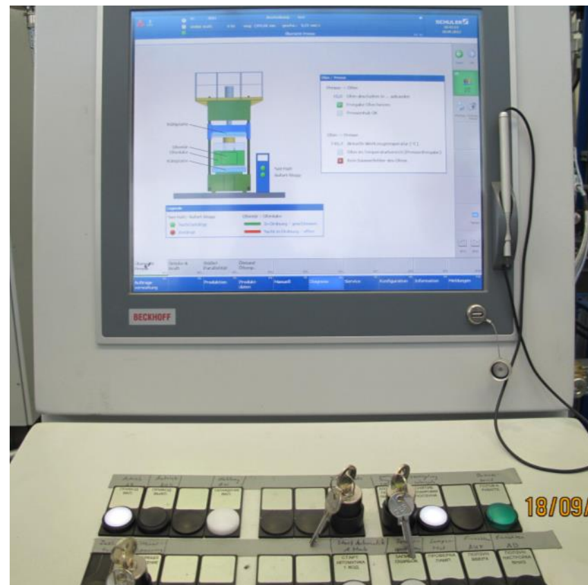
Bedientafel (hängend) mit Touchscreen (russ.)
